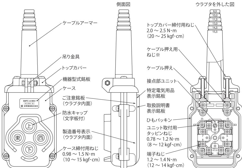
※90 (9.2 kgf) の力でケーブルを引っ張っても、ずれないように締め付けてください。
