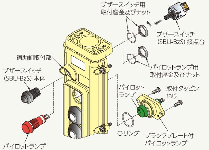
※釘数5点以下の押釦スイッチに、補助釘取付部はございません。パイロットランプを組み付ける場合は、blankプレート付パイロットランプをご使用ください。
