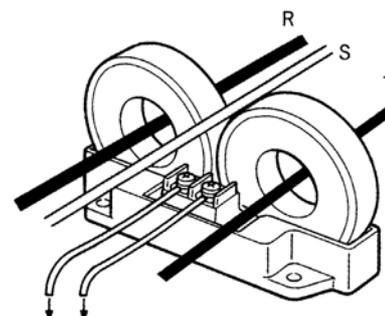
b) 負荷が大きく負荷電流が定格 (160AT) を超える場合または動力線の線径が太く規定の貫通数が入力できない時には、市販の変流器 (CT1, CT2) と組み合わせることで結線してください。その際には市販の変流器および負荷センサー (CTL-W) の入力方向をそれぞれ合わせてください。
